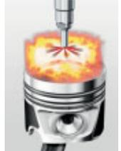
Jeder zweite Audi, der heute verkauft wird, ist ein Diesel. Was so selbstverständlich klingt, sorgte vor 20 Jahren für größte Aufregung: Audi revolutionierte den Markt mit dem ersten 2,5-Liter-TDI-Motor. Durch Entwicklungen wie die Common Rail Technologie ist TDI® inzwischen noch effizienter. Piezo-Injektoren sorgen für eine feine und präzise Kraftstoffverteilung. So sind die Motoren seit dem ersten TDI um durchschnittlich rund 30 % sparsamer geworden, während sich die spezi-
